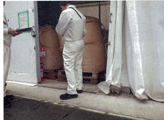
保管状況 コンクリート床に木製パレット2枚敷き、フレキシブルコンテナを2ないし3段積み
