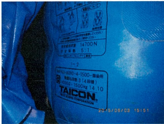
指定廃棄物のフレキシブルコンテナを確認 ランニング型のフレキシブルコンテナに入れ2重化した。
