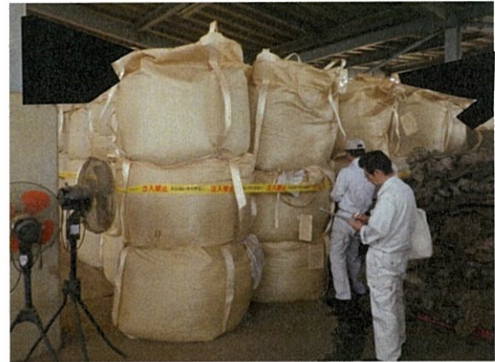
保管状況 遮へい用山砂入り土のう
