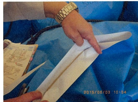
仮設倉庫内 袋口の接着状態
