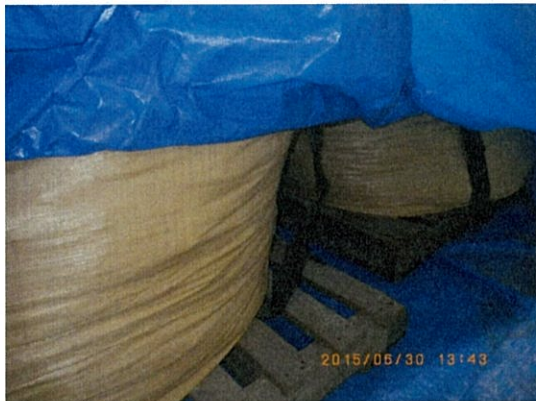
フレキシブルコンテナ（飛灰固化物を収納）
