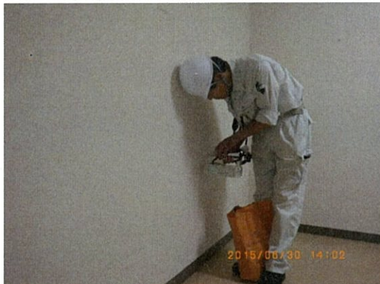
囲い境界の線量測定（保管場所シャッターに向かって左側の階段室）
