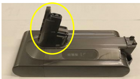
(クリーナー用電池の端子部露出)
