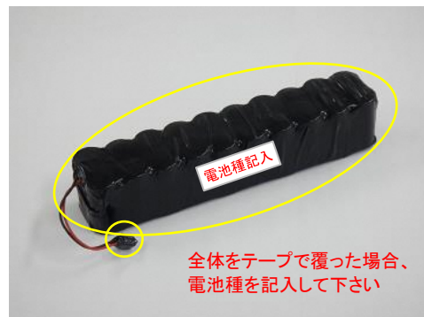
(チューブケースの被覆固定／コネクタ部被覆)
