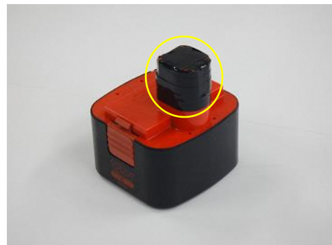
(電極端子部の被覆)
