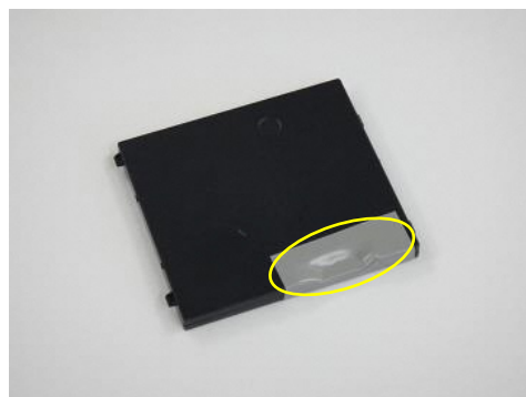
(電極端子部の被覆)
