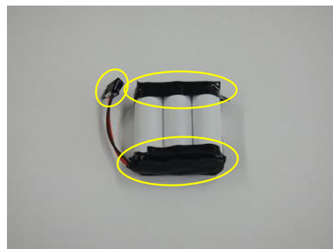
(電池端子連結部／コネクタ部の被覆)
