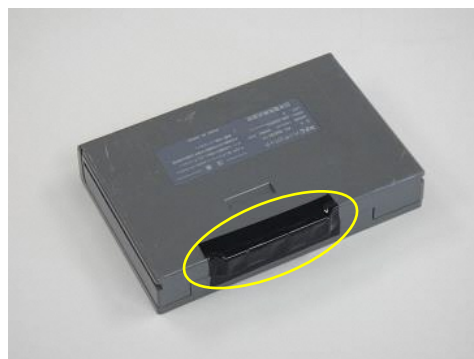
(電極端子部の被覆)
