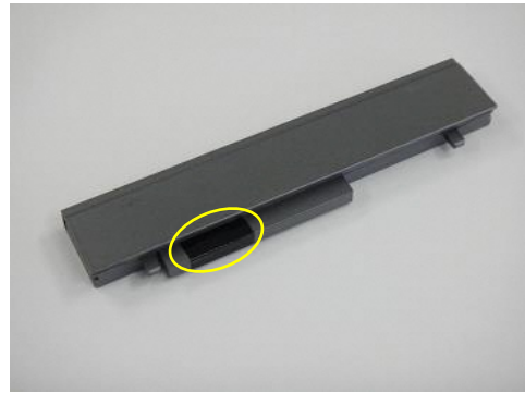
(電極端子部の被覆)
