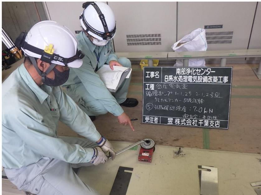
・盤を設置する架台を支えるアンカーが計算値以上の耐震性があるかの確認
