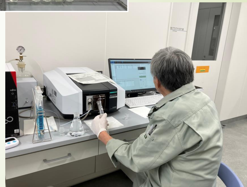
紫外可視分光光度計で測定
