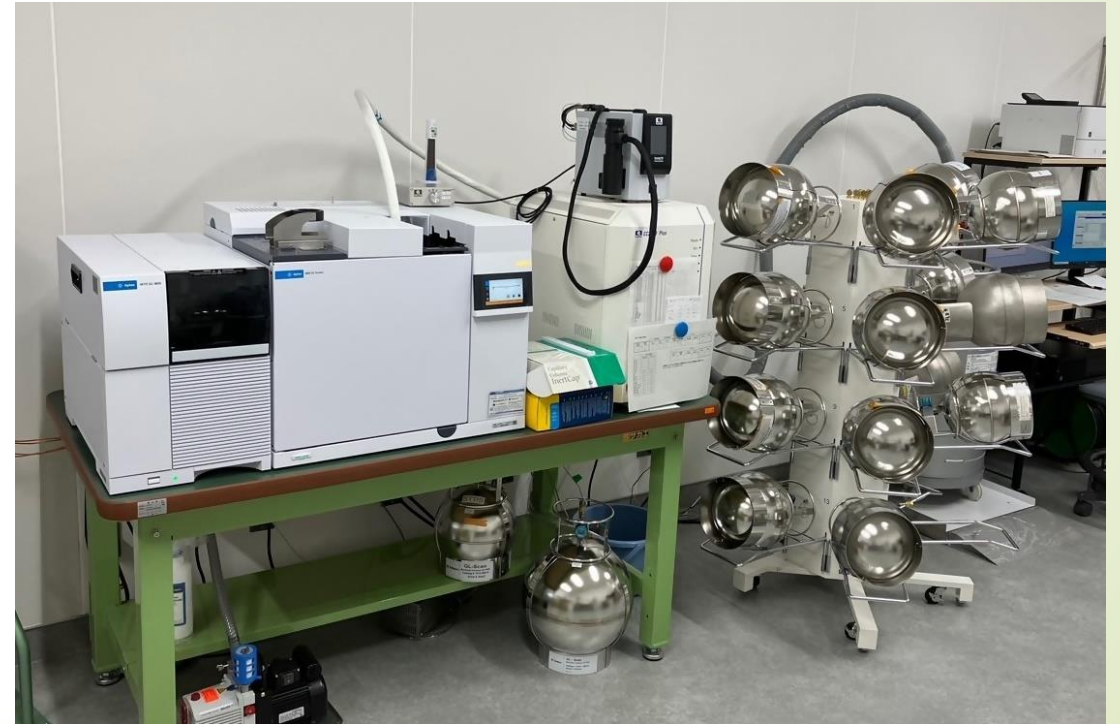
ガスクロマトグラフ質量分析計（GC/MS）で測定
