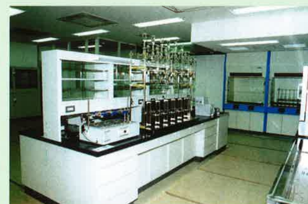
⑥ 分析室 定められた処理水質になっているかどうか毎日水質分析を行っています。また、流入水に対しても適切な処理が行えるよう常に監視しています。
