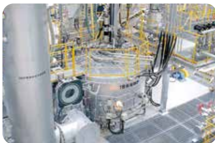
↑ 炉の中心部は20,000度~30,000度!! 周辺でも3,000度以上になるプラズマ式溶融炉
