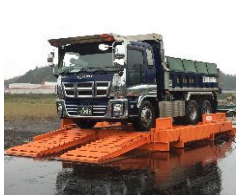
タイヤ洗浄設備例
