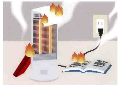
◆復電時の電気火災例 復電後、電気製品に落下した可燃物から発火
