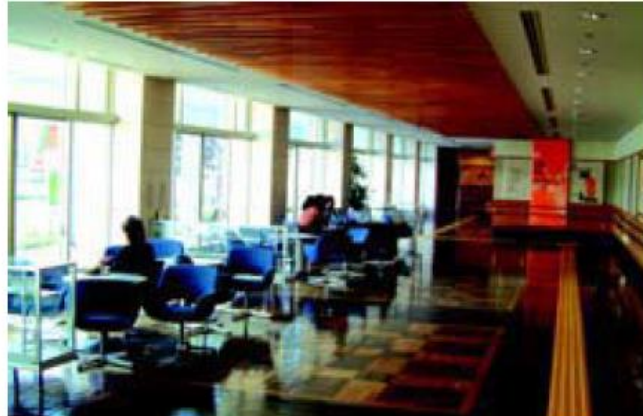
廊下の片側に窓を設けることにより、建物形状をわかりやすくする (千葉市：ハーモニープラザ)
