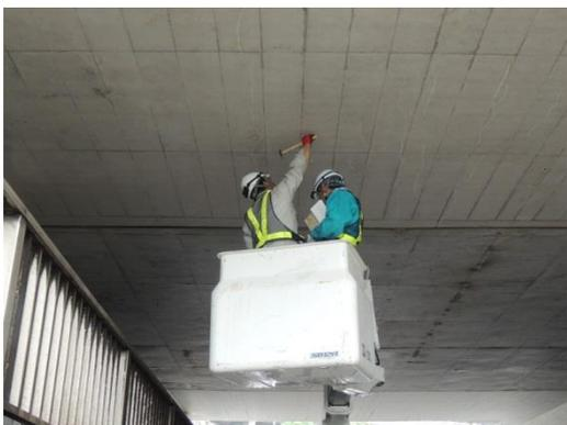
打音検査\*による点検状況。
