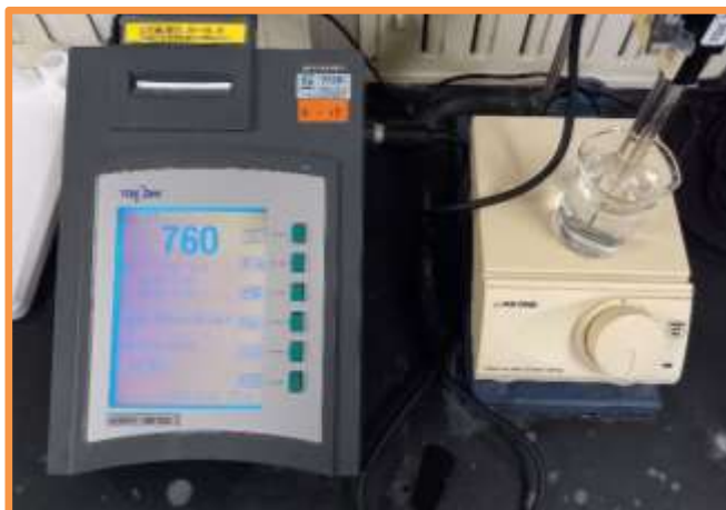
写真 検査の様子（右のビーカーに電極が浸けてあり、左の指示計で値を読み取ります）
