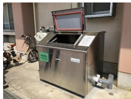
[ 小学校に設置している生ごみ処理機 ]
