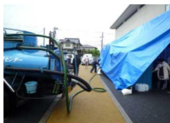
①し尿汲み取り作業(避難所)
