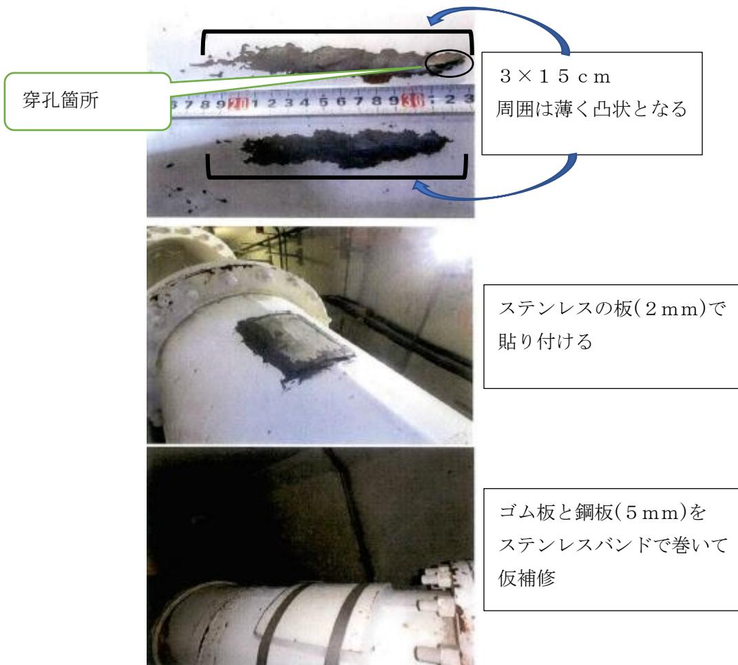
ごみを引っ張った勢いで、曲がり部分の配管の壁面にごみがぶつかる箇所で配管が削られ、または伸びてしまって穴が開いております。この時は、薄くなっている場所を中心とし、40 cmの幅の当て板をして、仮補修を行いました。共同溝内に関しては、この破損部分を参考に、来年度から配管の肉厚測定を行い、測定結果より、著しく薄くなっている配管の更新計画を立てていく予定です。
