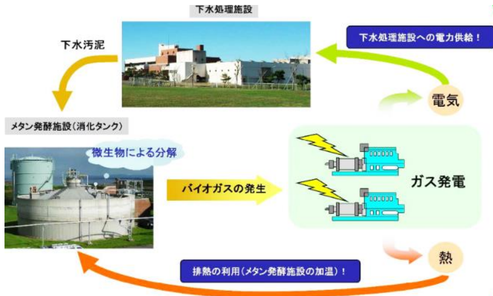
図表 1-5-17 下水汚泥を活用した発電
