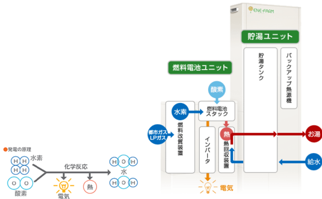
図表 1-5-22 家庭用燃料電池エネファームの仕組み
