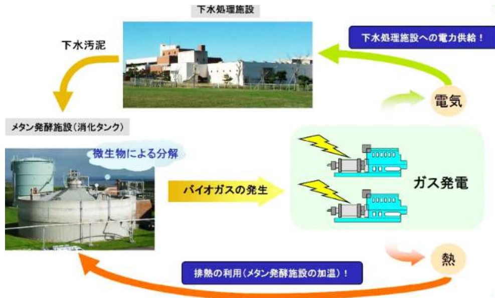
図表 1-5-13 下水汚泥を活用した発電
