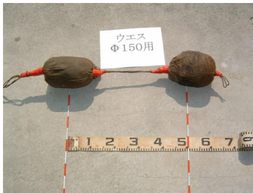
通信用φ 150管の通過試験器の形状（参考図）
