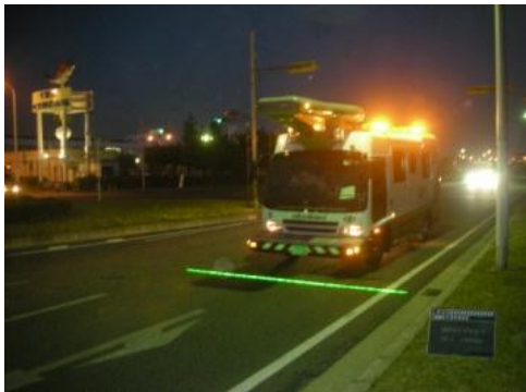
写真 4-1 路面性状調査状況
