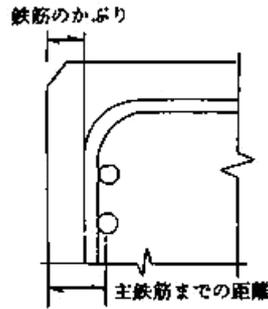
図 3 - 1 鉄筋のかぶり
