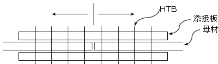
図 2 - 1 ボルト締め付け順序
