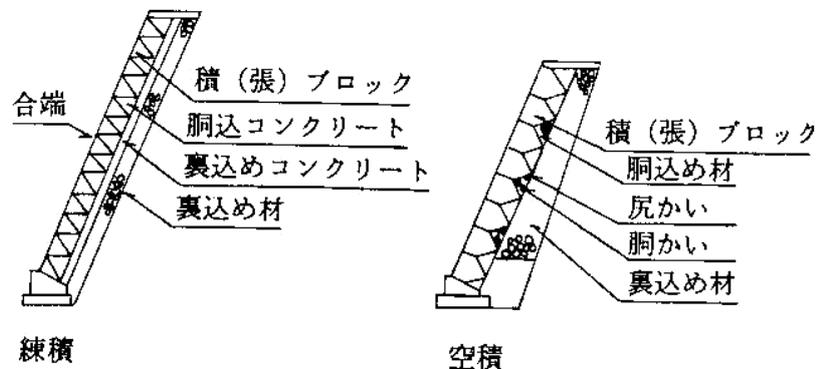
図2-5 コンクリートブロック工
