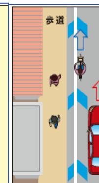
車道の左端に自転車の通行位置・進行方向を示す矢羽根マークを路面に表示します。
