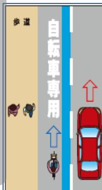
自動車が通行する車線の左端に自転車専用の車線を設置します。
