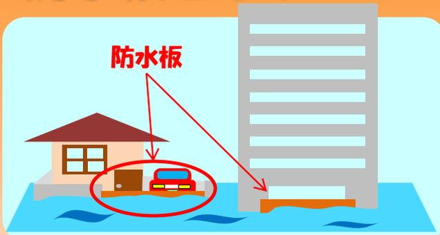
建物等の出入口に設置し、金属板等の浸水に耐える材質で、取りはずし又は移動が可能なものをいいます。
