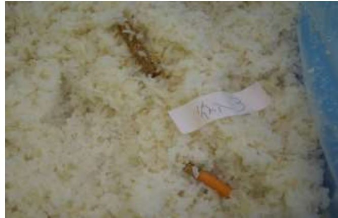
4-1 保温箱に「たばこ」を折って投入した3時間後の状態
