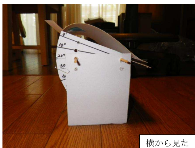
図 29 モデル翼の迎え角を 10^\circ 刻みで調節できる装置
