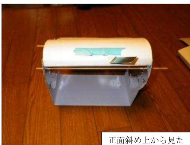
図 29 モデル翼の迎え角を 10^\circ 刻みで調節できる装置
