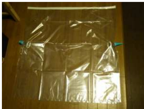
図 32 ビニール袋の端と端に接続用口金をつける
