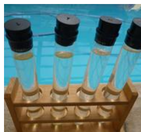
蓋を固定し、3mの深さに沈める
