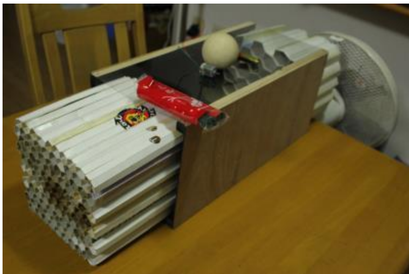
蜂の巣型整流器(細)(粗)、線香、モーター、ボール、電池、ペンライト、扇風機
