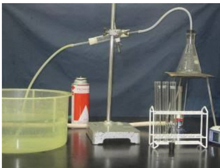
[図2] 加熱水蒸気による水蒸気改質の様子
