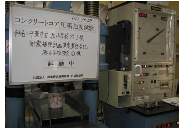
圧縮強度試験
