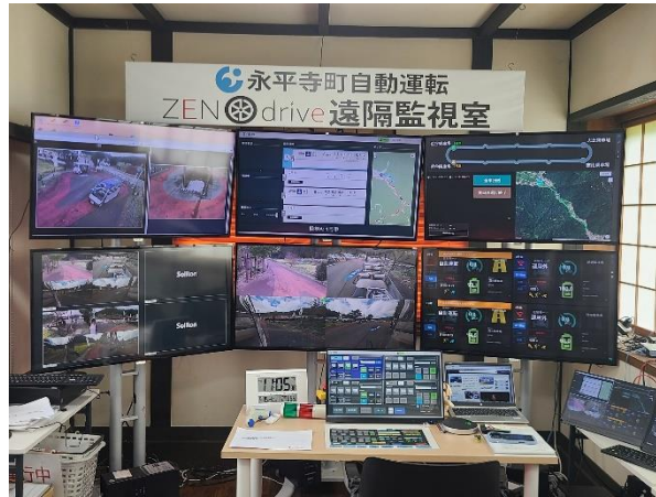
【レベル4 自動運転遠隔監視室】
