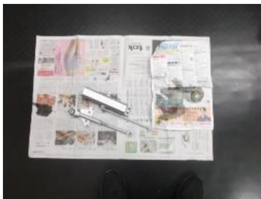
ドアクローザーを分解
