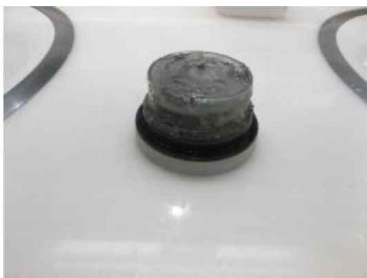
埃などの詰りを確認
