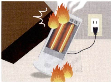
◆地震発生時の電気火災例 重い物が倒れて、壊れた電気製品から発火
