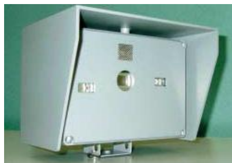
■放火監視機器の例（監視カメラ内蔵型）
