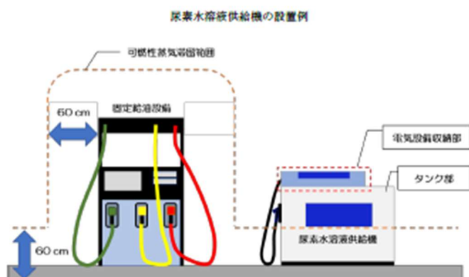
図1 尿素水溶液供給機（電動ポンプにより払い出すタイプ）
