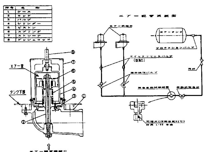
**底弁自動閉鎖装置の構造**
