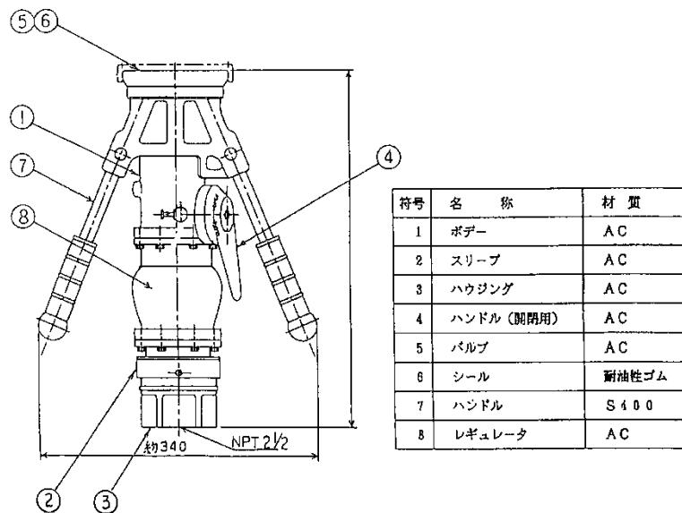
g 給油ホース構造図（第2-2-20図参照）
