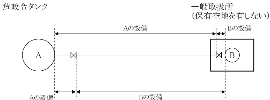
第2-1-6図 危険物タンクと製造所（一般取扱所）の例（その4）
