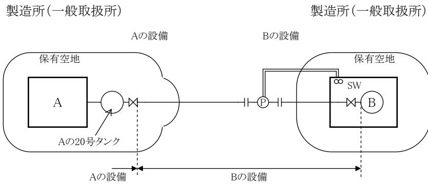
(2) 危険物タンクと製造所（一般取扱所）の場合
