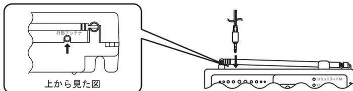
2. 告知放送受信機の右側面にあるスライドスイッチが「アンテナ」側になっていることを確認し、「ON/OFF ボタン」を短押ししてラジオを起動させてください。「選局ダイヤル」があるタイプはコミュニティFMを選局してください。(コミュニティFMのチャンネル表示ランプが点灯します。)
