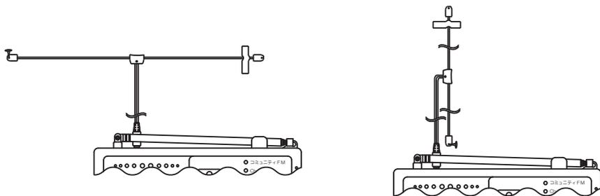
4. 告知放送受信機の「受信ランプ」表示で受信状態が良好であることを確認してください。良好でなければ受信状態が良くなる位置を探してFM フィーダーアンテナを張りなおしてください。
