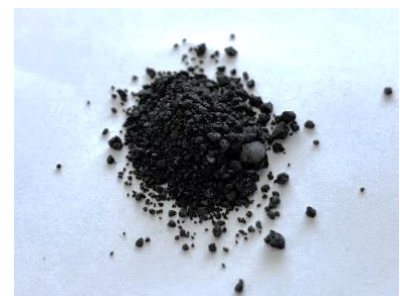
下水汚泥で生成された固形燃料
