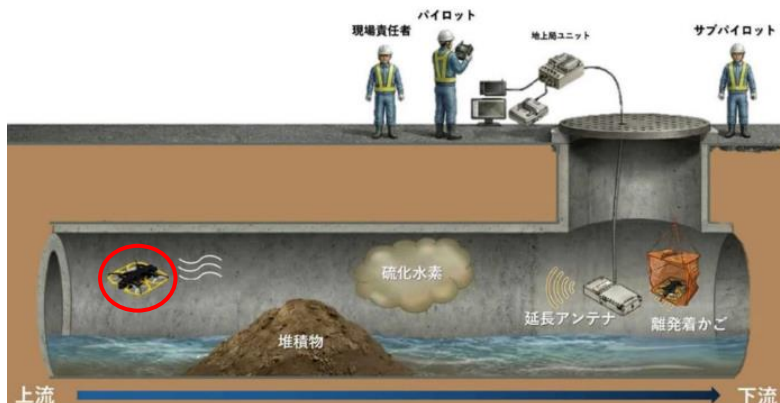
下水道点検のオペレーションイメージ
