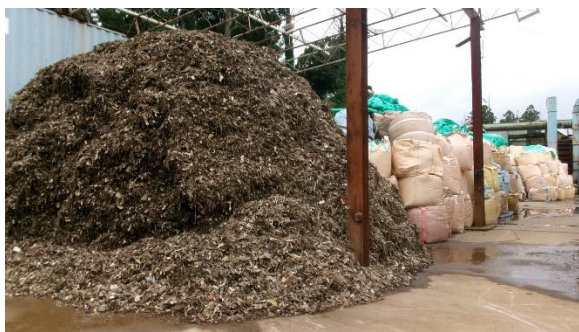
屋外保管場の要件を満たさない場所に保管
