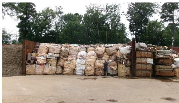
容器を用いず保管する場合の積み上げ高さ超過
