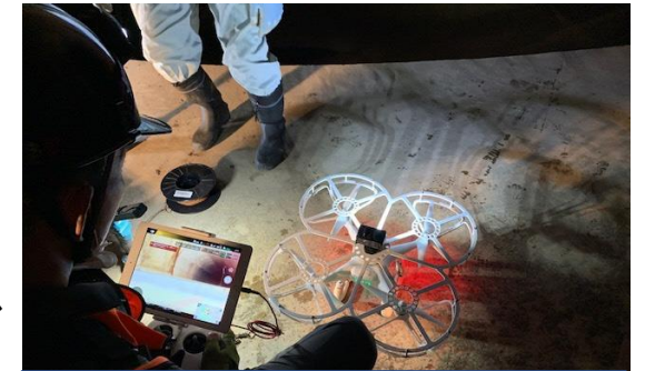
ドローンによる管内調査
