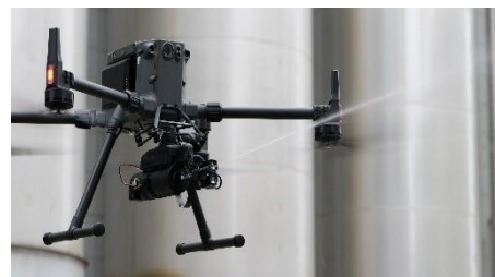
スプレー缶噴射装置を付帯したドローン
