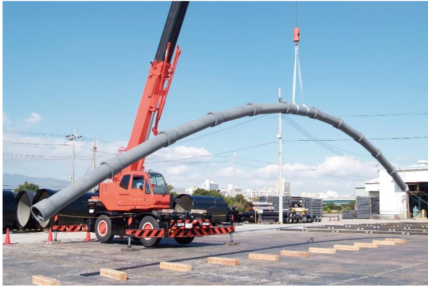
図 3-12 耐震管（ダクトイル鋳鉄管 GX 型）の抜け防止実験
