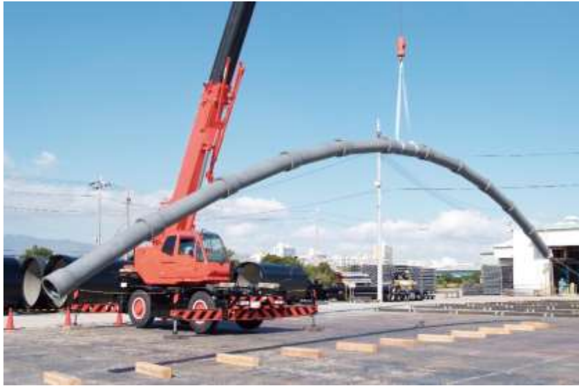
図 3-12 耐震管（ダクタイル鑄鉄管 GX 型）の抜け防止実験
