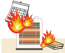
復電時の電気火災例 復電後、電気製品に落下した可燃物から発火
