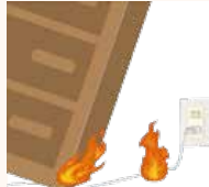
地震による電気火災例 電源コードの被覆が破れて短絡（ショート）により発火
