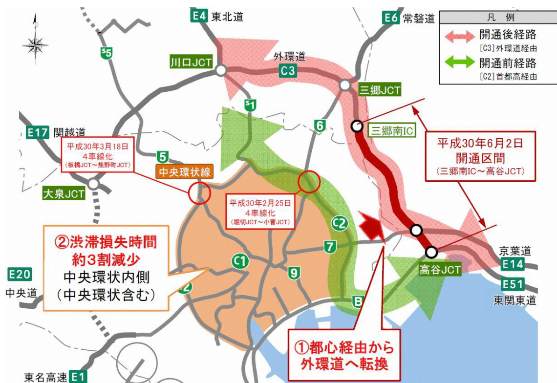
図表 49 首都圏外郭環状道路(高谷 JCT～三郷南 IC 間)開通前後の経路と渋滞状況の変化
