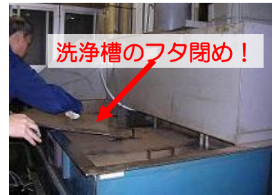
洗浄槽のフタをすると蒸発量が1/2~1/4程度まで減ります。 (東京都VOC対策ガイド(工場内編)より)
