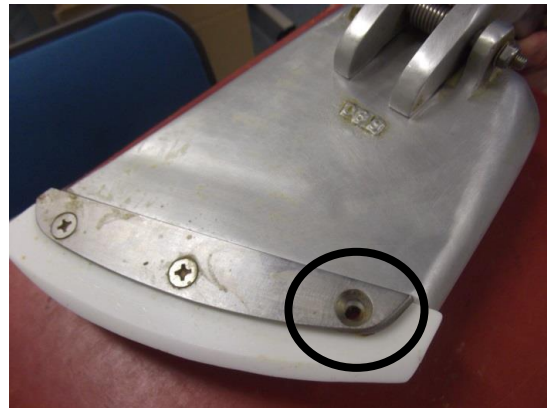
グランドケトル釜の攪拌用ヘラのネジ1本欠損
