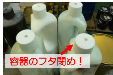
フタ開放で8時間に60gの溶剤が蒸発します。(日本印刷産業連合会 印刷産業におけるVOC排出抑制自主的取組推進マニュアルより)
