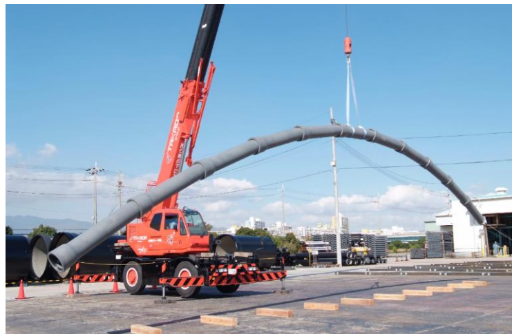
図 3-11 耐震管 (ダクタイル鉄管 GX 型) の抜け防止実験
