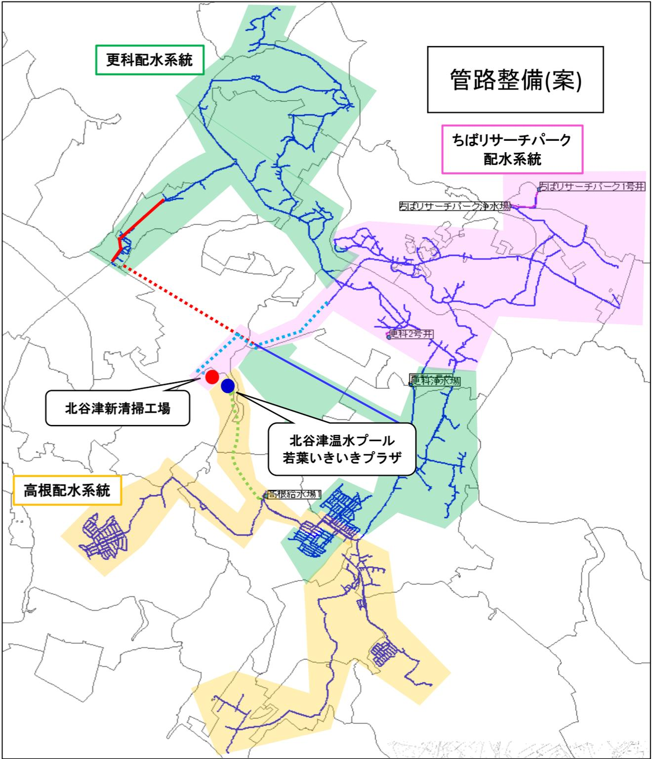
●●●●● 新設管      — 増径箇所      — 既設管
